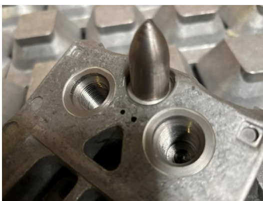
Odpadni kosi aluminija z jeklenimi vložki
